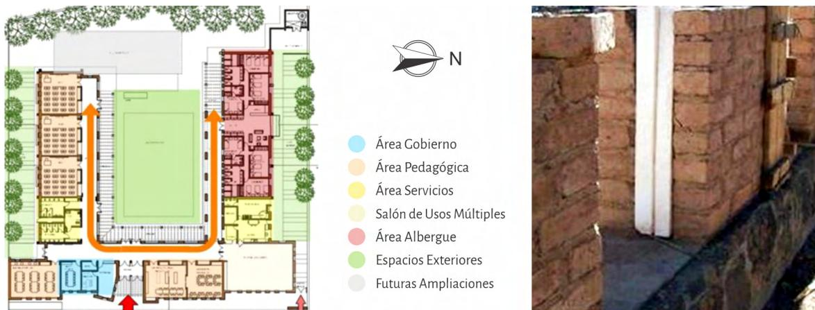
Figura 8: Colegio Secundario N°39, Catamarca. Izquierda: Planta con identificación de áreas. Derecha: muro doble con aislación de 7cm y espesor total de 45cm. Fuente: Walter et al., 2016.
